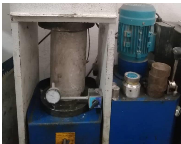
شکل ۶: آماده سازی نمونه جهت آزمون مدول الاستیسیته
