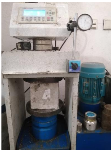
شکل ۴: نمونه مقاومت فشاری در دستگاه جک بتن شکن
