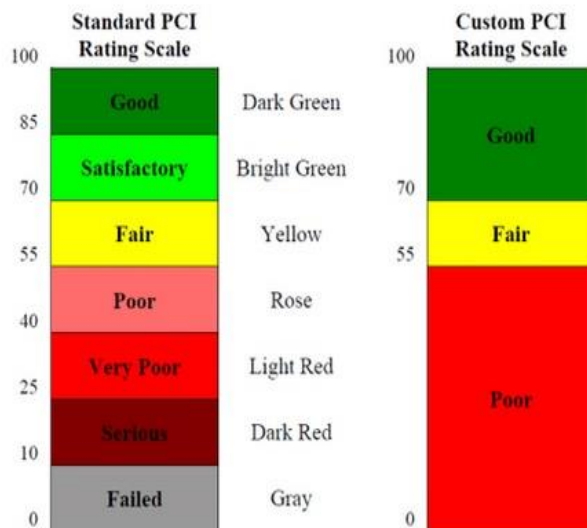
شکل ۱: مقیاس استاندارد رتبه بندی PCI توسط ASTM (ASTM, ۲۰۰۷)
