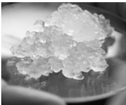
شکل ۶: ساختار شفاف ژل نانوسلولز (ایچون و همکاران، ۲۰۱۰).
