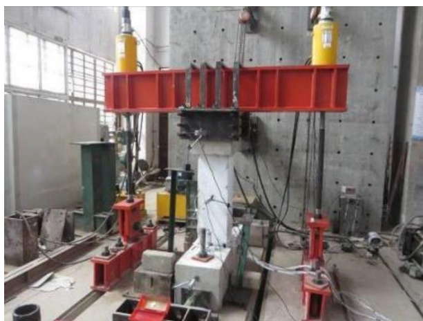
تصویر ۴ ستون کوتاه تحت بارگذاری جانبی در مطالعه آزمایشگاهی [۱]
