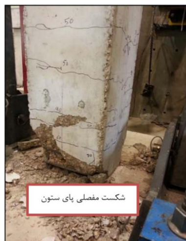
(۱) نوع شکست مفصلی در محیط آزمایشگاه [۱]
