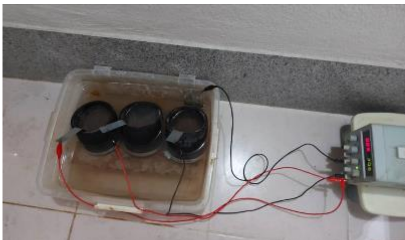
تصویر ۶ تست RCMT بر روی نمونه های مورد مطالعه
