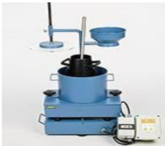
شکل ۱: دستگاه vebe اصلاح شده برای بتن غلتکی در آزمایشگاه بتن دانشگاه تربیت مدرس
