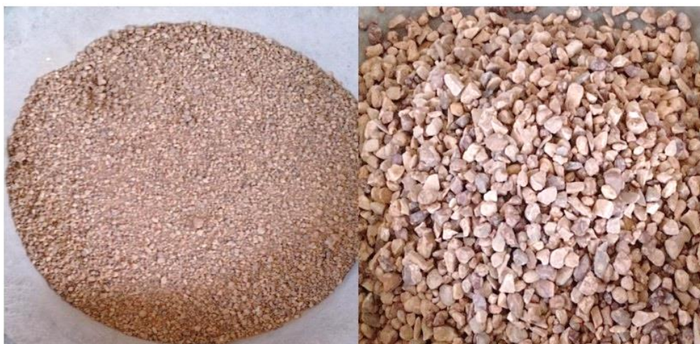
تصویر ۲ دانه بندی شن و ماسه مورد استفاده جهت تهیه نمونه بتنی
