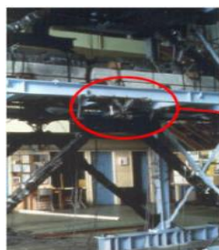
شکل ۲. میراگر تسلیمی مثلثی شکل (TADAS) و منحنی پسماند آن [۱۰].
