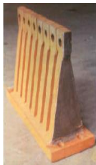
شکل ۲. میراگر تسلیمی مثلثی شکل (TADAS) و منحنی پسماند آن [۱۰].
