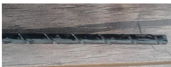
شکل ۳: تصویر میلگرد GFRP مورد استفاده در آزمایش بیرون کشیدگی.
