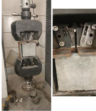
شکل ۷: دستگاه آزمایش مقاومت پیوستگی بین میلگرد و بتن مورد استفاده و جزئیات آن.
