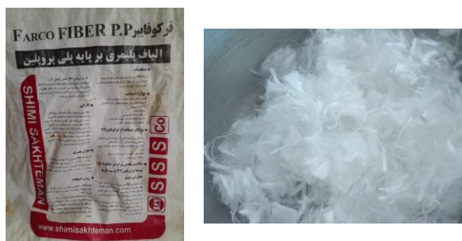
شکل ۲: الیاف پلی پروپیلن مصرفی در بتن.
