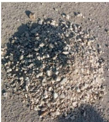
شکل ۱: سنگدانه ها
