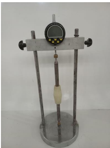
شکل ۳: تصویری از دستگاه جمع شدگی و نحوه قرار دادن نمونه
