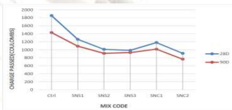
نمودار ۴؛ مقایسه ۲۸ و ۹۰ روزه نتایج آزمایش نفوذ یون کلر تسریع شده با رنگ
