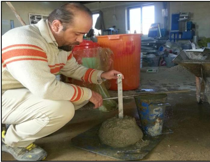
شکل ۴: انجام آزمایش اسلامپ بر روی بتن تازه
