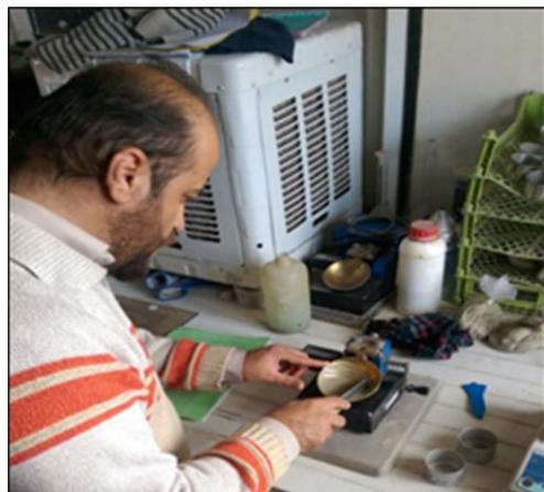
شکل ۳: انجام آزمایش حدود اتربرگ بر روی بنتونیت
