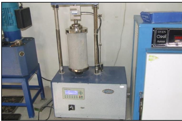
شکل ۶: جک بتن پلاستیک
