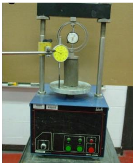
شکل ۳- نمونه در گسیخته شده در دستگاه تک محوری با افزودن ۰/۸٪ نانوسیلیس
