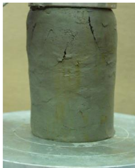
شکل ۳- نمونه در گسیخته شده در دستگاه تک محوری با افزودن ۰/۸٪ نانوسیلیس
