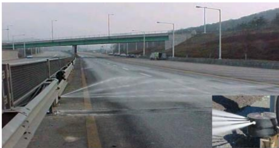
شکل (۱) روش مکانیزه پخش مواد زد یخ به روی جاده (Thomas et al., 1996).
