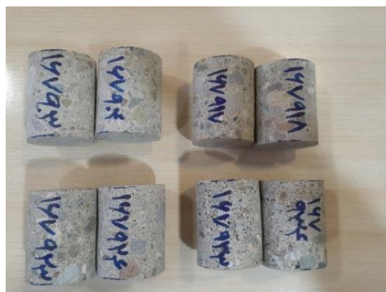
شکل ۷ - نمونه‌های مغزه‌گیری شده و بریده شده برای جذب آب
