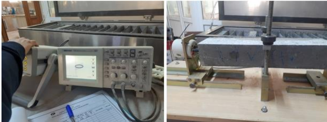
شکل ۹ - تعیین فرکانس نمونه بتن
