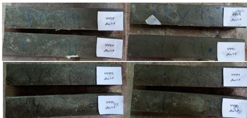
شکل ۱۰ - نمونه‌های آزمایش انجماد و ذوب پس از ۱۰۴ سیکل یخبندان و ذوب
