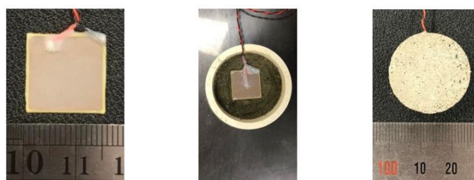
شکل ۱۷: ساخت سنگدانه‌ی هوشمند (Choi et al., 2022)
