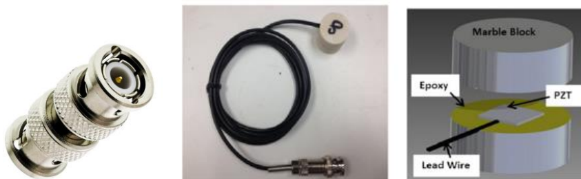
شکل ۷: ساختار سنگدانه‌ی هوشمند (SA) (Kong et al., 2013)
