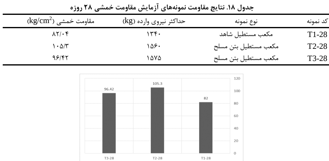
شکل ۱۴. نمودار نتایج مقاومت نمونه‌های مکعب مستطیل آزمایش مقاومت خمشی ۲۸ روزه ( \text{kg/cm}^2 )
