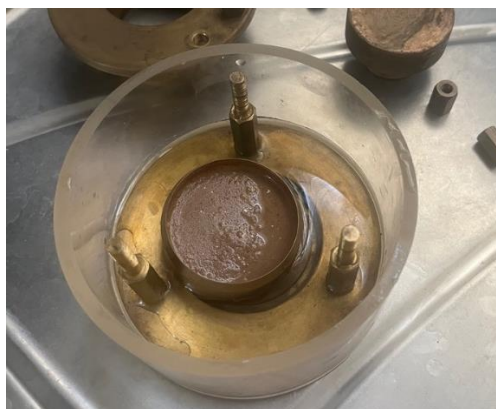
آزمونه فشرده شده بهسازی شده با نانوالومینیوم پس از آزمایش تحکیم
