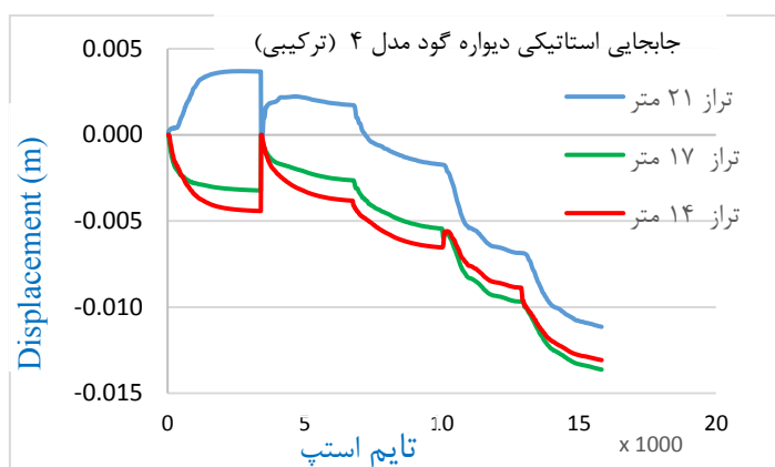
نمودار ۲: جابه‌جایی دیواره گود مدل‌های تحت بار استاتیکی
