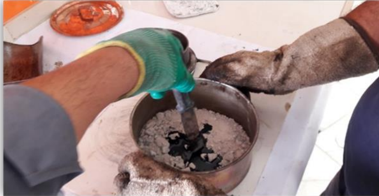
شکل ۳- اختلاط مصالح سنگی با قیر جهت آزمایش مارشال
