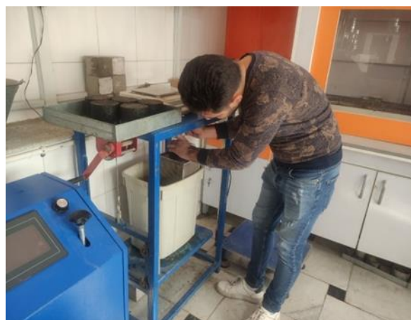
شکل ۶- تعیین وزن مخصوص حقیقی آسفالت متراکم شده
