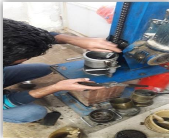
شکل ۴- متراکم کردن نمونه مارشال
