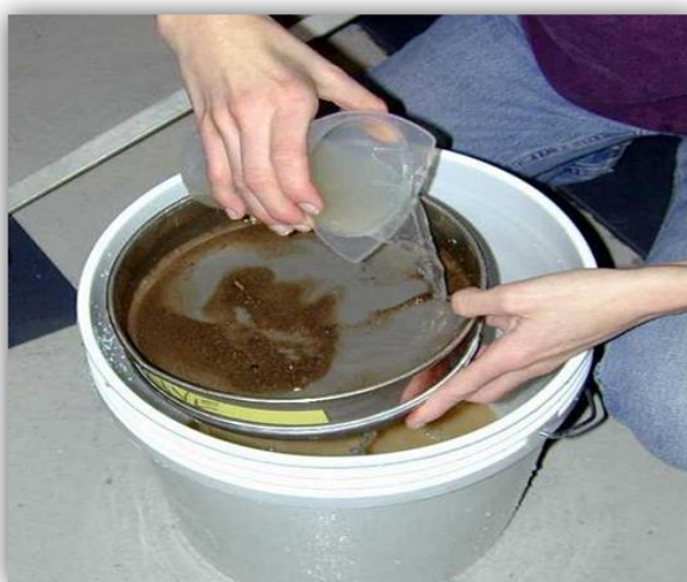
شکل ۲- تعیین مصالح عبوری از الک شماره ۲۰۰
